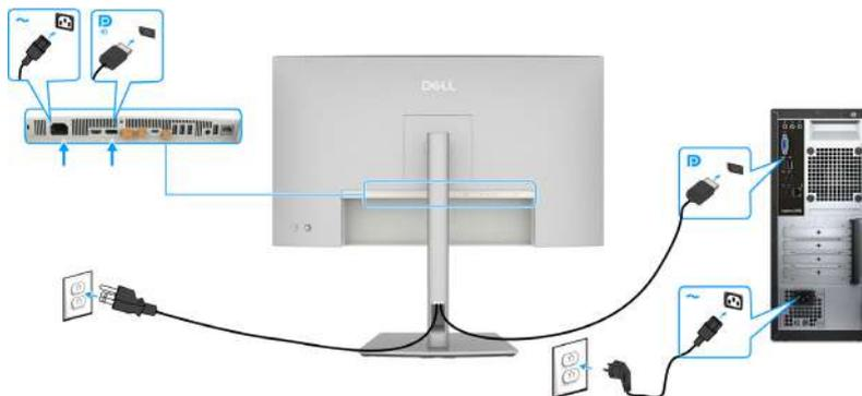
Рис. 30. Подключение кабеля DisplayPort
