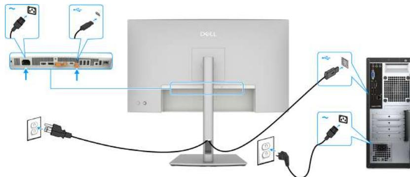
**Рис. 37.** Подключение кабеля USB-C (A – C)
