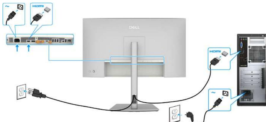
**Рис. 29.** Подключение кабеля HDMI
