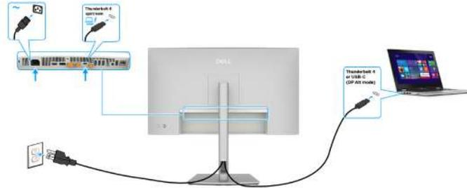
**Рис. 40. Подключение кабеля Thunderbolt 4**
